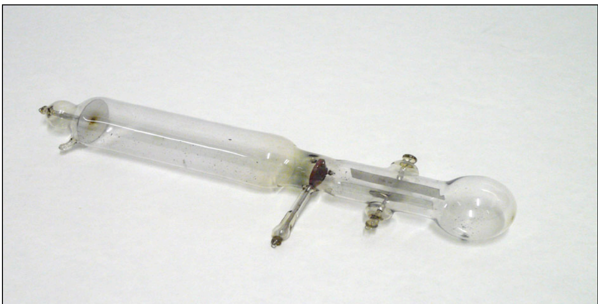
Tubo per esperimenti di deflessione elettrostatica (Inv. 20, Armadio D3)
