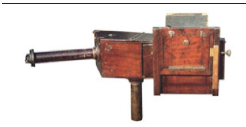
Figura 3 – Spettrografo a prisma di quarzo: sebbene gli esperimenti originali fossero effettuati mediante osservazione visuale, misure precise furono effettuate con questo spettrografo e rese pubbliche da Raman durante una conferenza in Bangalore il 16 marzo 1928.
