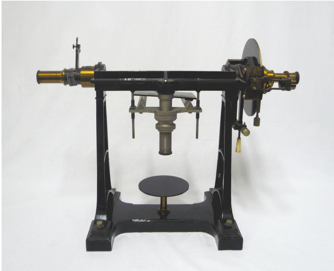
Figura 2 – Polarimetro, Ditta Franz Schmidt & Haensch (Berlino-Germania). (Inv. 128, armadio S1)
