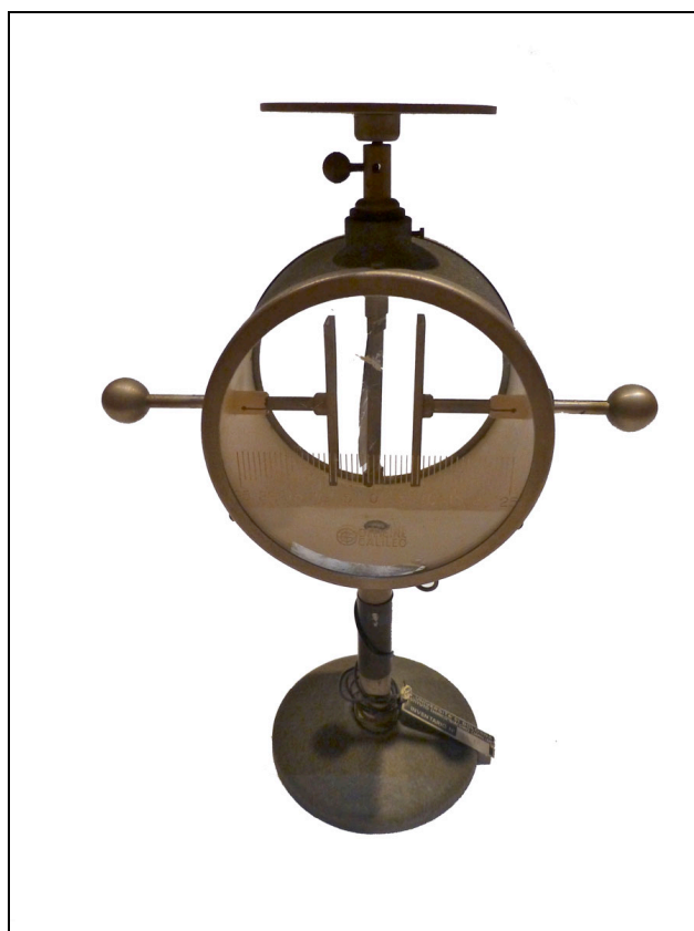
Figura 1 - Elettroscopio con condensatore , ditta Officine Galileo di Firenze (inv.61, armadio D3)
