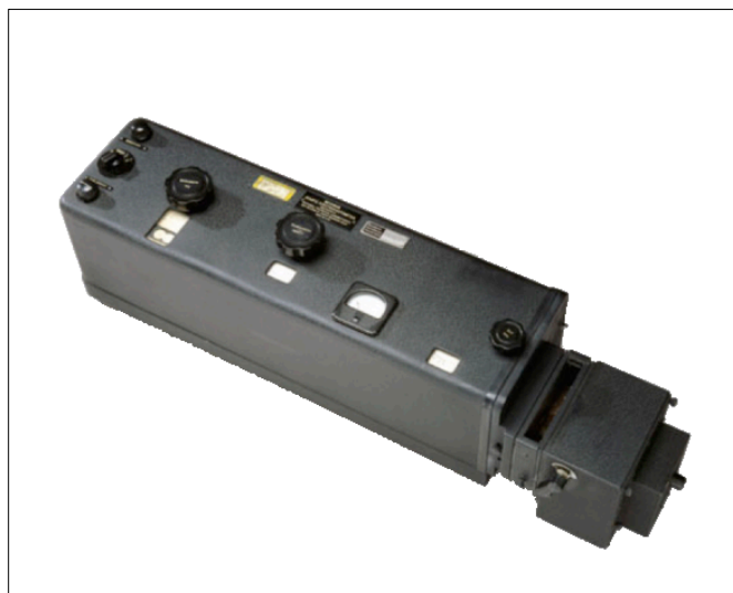
Figura 9 - Spettrofotometro Beckman DU. Notare a destra, l'alloggiamento per le vaschette, senza il coperchio (inv.202, Arm. 2P1).
