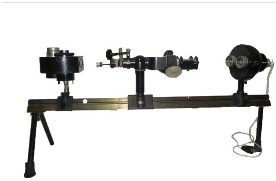
Fig. 7 - Fotometro di Pulfrich, con lampada a tungsteno (a destra) e Tyndallometro (a sinistra), ditta Zeiss – Jena (inv. 218, armadio 2P1).
