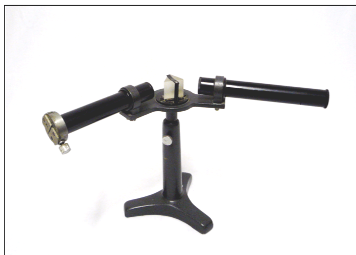
Fig. 1 - Spettroscopio su stativo a colonna, a 2 bracci, con prisma scoperto. (a) collimatore, (b) prisma, (c) cannocchiale. Ditta Leitz (Germania). Inv. 125, Armadio S1.
