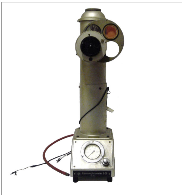
Figura 5 – Fotometro a fiamma della ditta Lange (inv. 286, Arm. 2P1).
