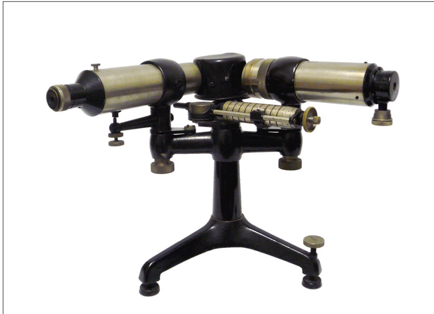
Fig. 2 - Spettroscopio su stativo a colonna, a due bracci perpendicolari, con prisma coperto; scala di lettura delle lunghezze d'onda visibile. (Ditta Zeiss-Jena Germania) (Inv. 124, Armadio S1).
